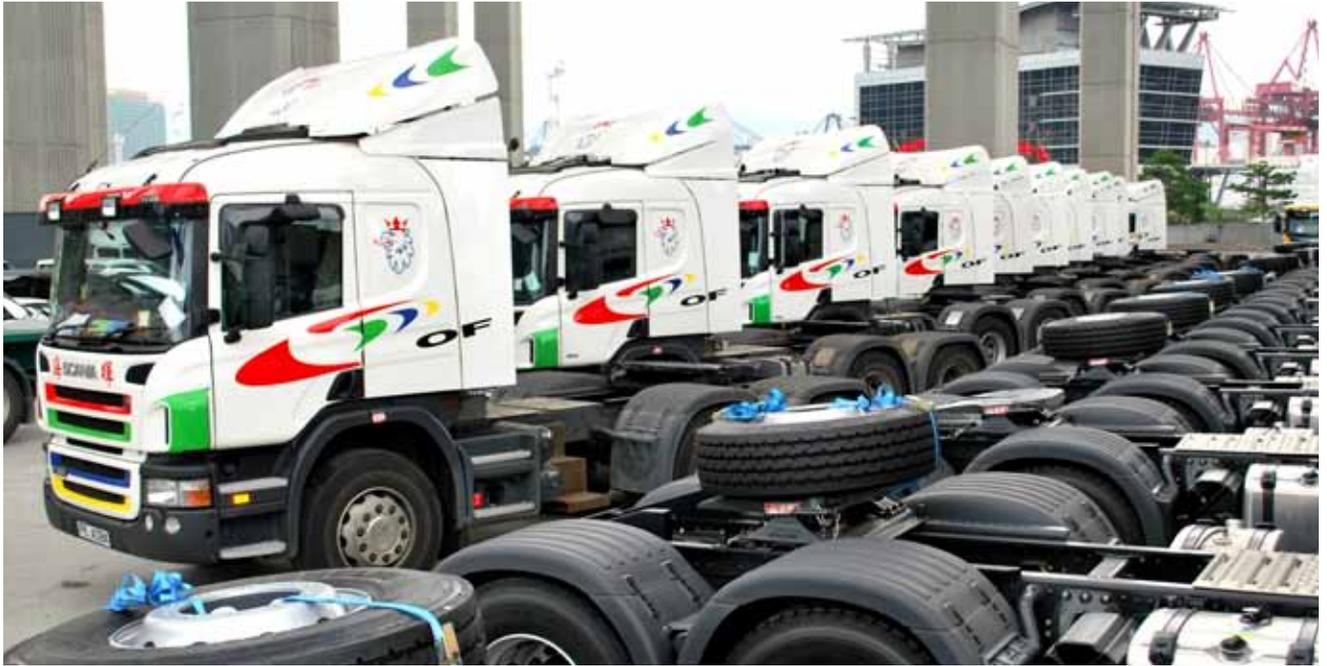
露了一個用車的獨特心得，就是絕大部分都採用尾軸可以升降的三軸型號，之所以如此，有哥自有一套獨特見解，他認為，當三軸拖頭將尾軸收起之後，其功能與兩軸拖頭沒有分別，但相反，兩軸拖頭就無法發揮三軸拖頭的效能，既然前者可以兩者兼顧，當然大量採用屬理所當然；另外，當車輛處於空載的時候，收起後軸行車絕對不會影響行車性能，相反可以藉此減低輪胎損耗，而
