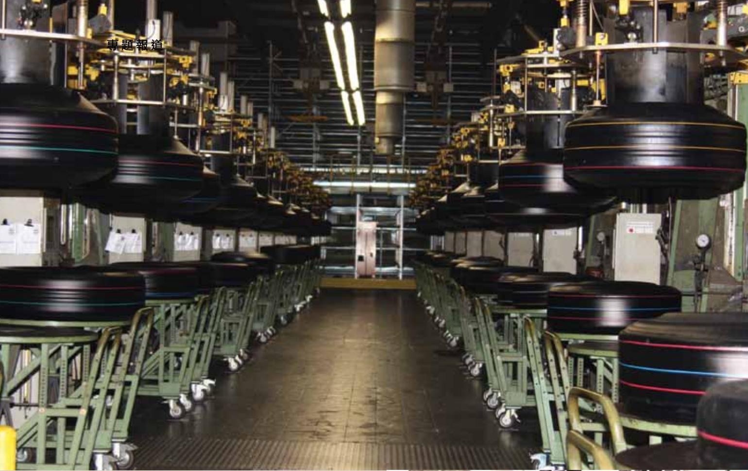
通常輪胎翻新有兩種方法：熱硫化翻新和預硫化翻新。只有經過仔細揀選及精心檢查的外胎才能用這兩種方法。兩者的製作工序實際沒有區別，不同的地方在於將外胎材料包覆於胎體的方法及橡膠硫化的方法。
